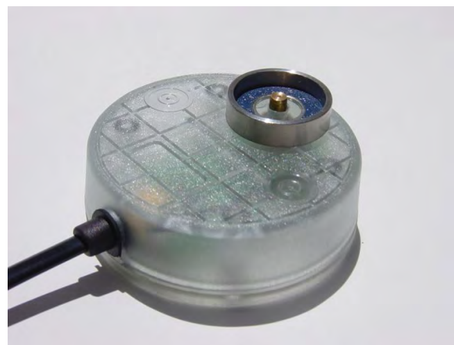
Plataforma de Descarga (DTU)
